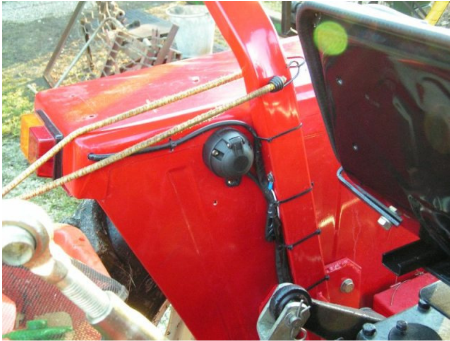
Åtgärd 5. Släpvagnsuttag monterat (även matning till fjärrstyrd vinsch), samtidigt drogs kablage till bakljus om. En kvist hade gjort "rent hus" för kablage när det var monterat på insidan av bakskärmarna.
