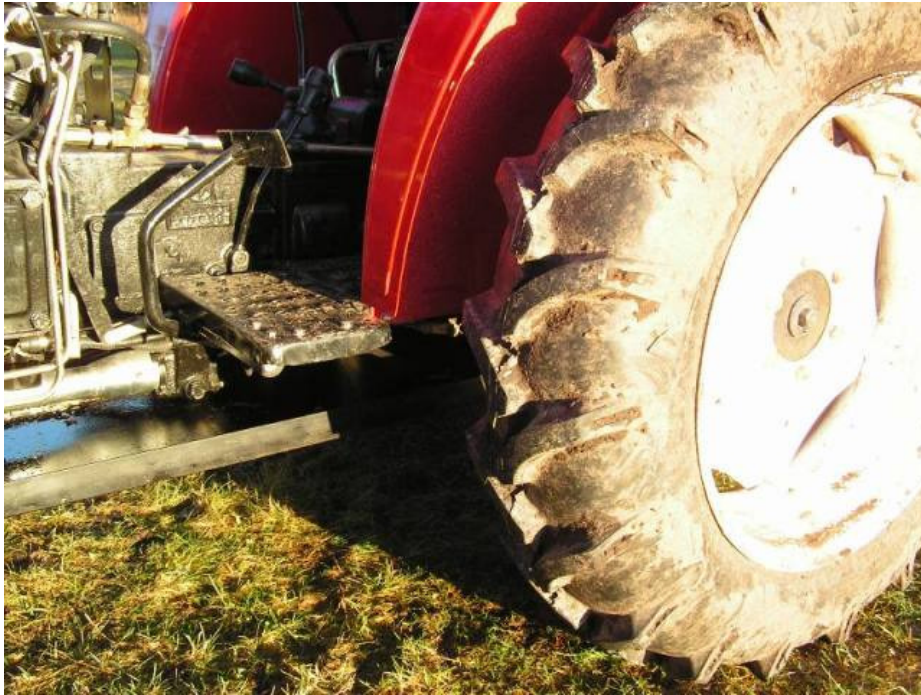
Åtgärd 1. Hjulvikter demonteras. Insteg / trappsteg tas bort, bultarna får sitta kvar för minskad halkrisk.
