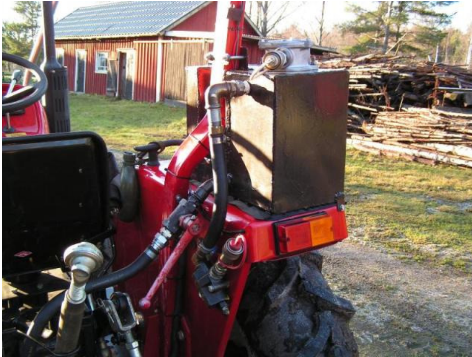
Åtgärd 7. Utrustning för yttre hydraulik (griplastarkärre). Tank med returfilter tillverkat och monterat.
