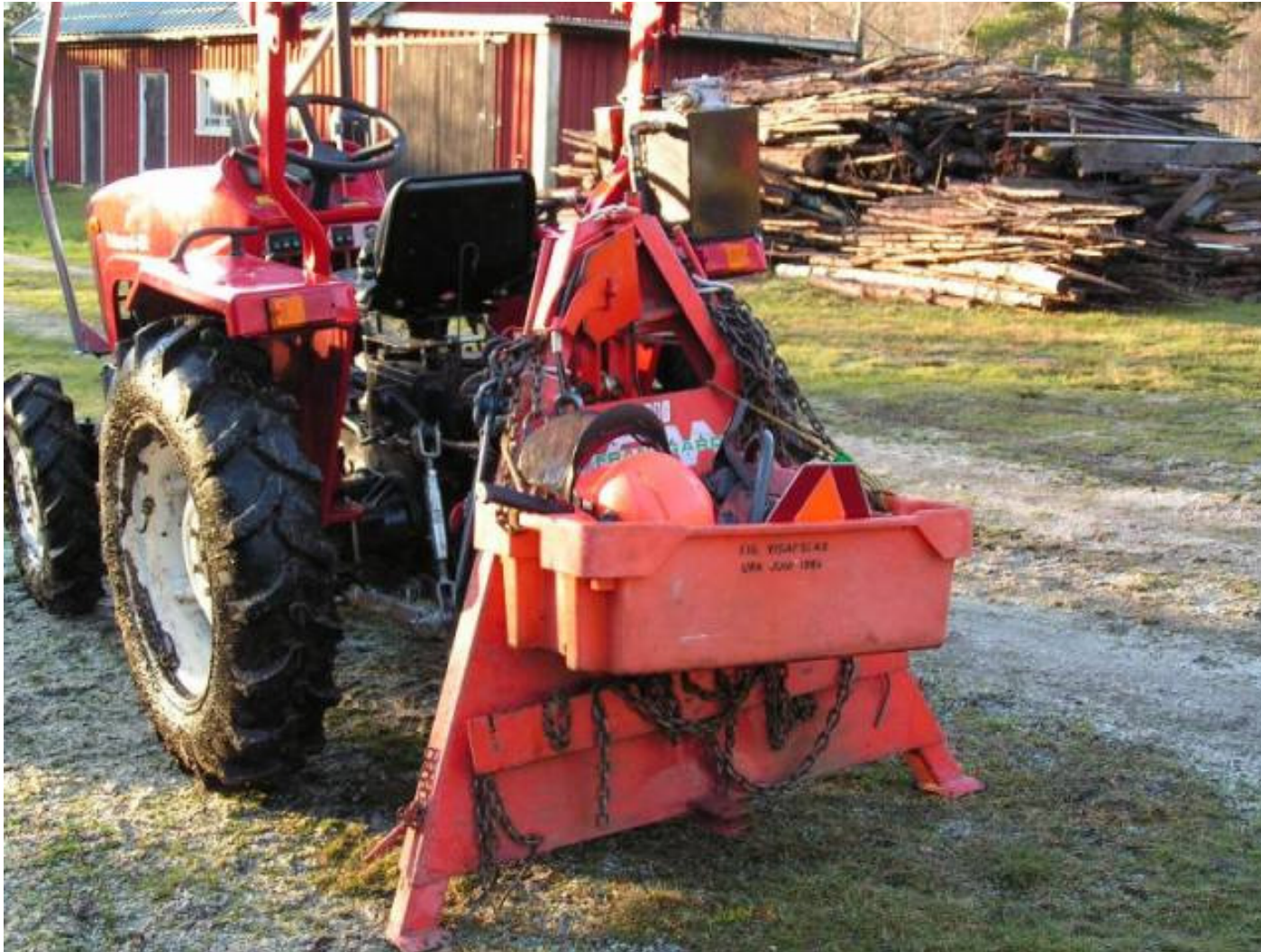
Åtgärd 9. Vinsch med back för huggarutrustning monterad.
