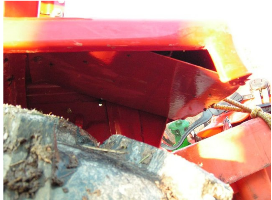
Åtgärd 6. Skyddsplåtar monterade på insida bakskärm som skydd för baklampor och bakkant skärm.
