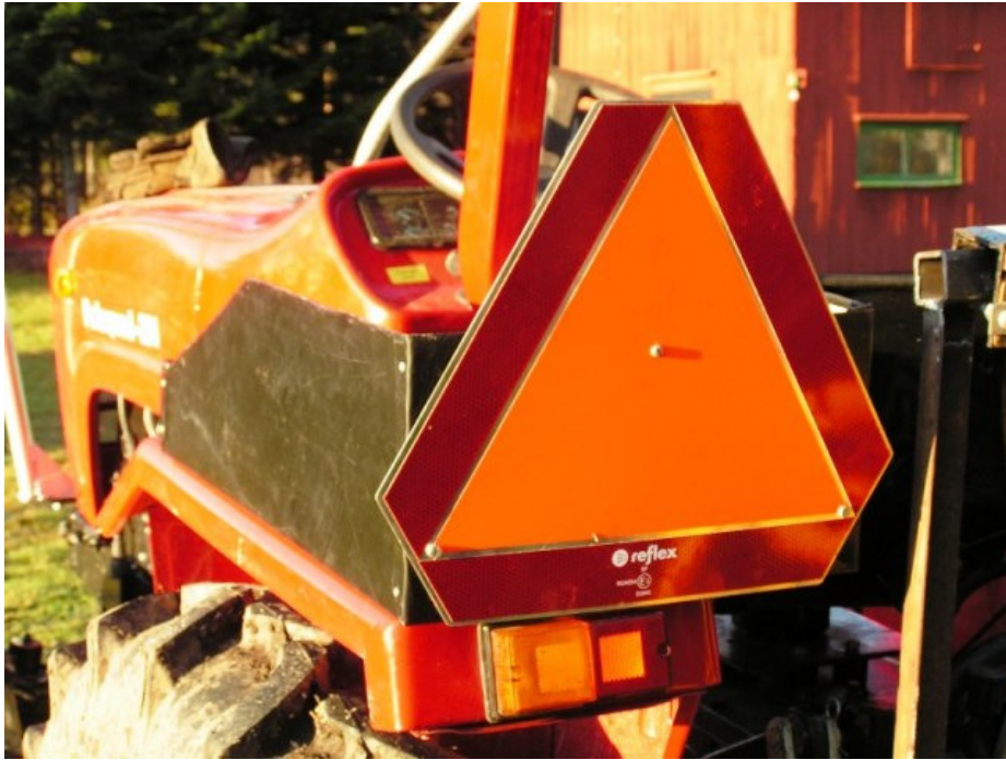
Åtgärd 10. Låda vänster baksärm med plats för motorsåg, bensin/olje dunk samt lite massäck.
